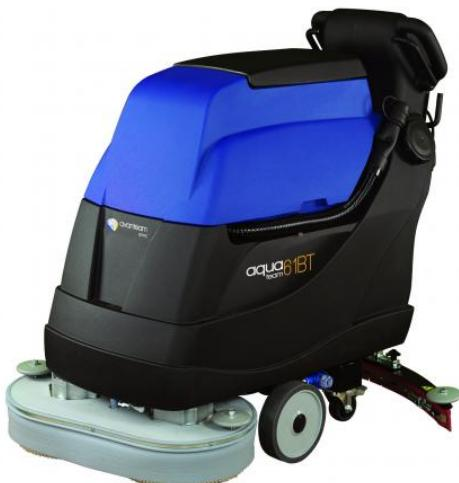
L'Aquateam 61BT est une autolaveuse à batterie conçue pour les professionnels. Avec une capacité de travail de 2300 m<sup>2</sup>/h, elle garantit des résultats impeccables sur des surfaces dures ou souples. Sa largeur de nettoyage de 610 mm combinée à une raclette de 880 mm assure un séchage optimal. Sa traction électrique, avec marche arrière, facilite les manœuvres dans les espaces restreints, ce qui en fait l'outil idéal pour tous les environnements.
