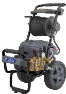
Nettoyeur hp 200 bars, 900 l/h, préconisé pour une utilisation en continu de maximum 6h.
