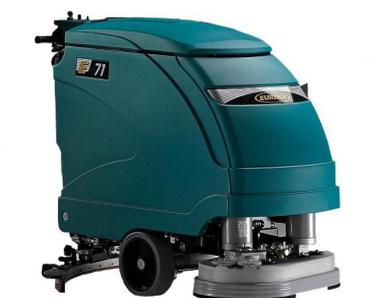
Autolaveuse robuste et compacte, idéale pour le nettoyage des surfaces comprises entre 2000 m<sup>2</sup> et 3000 m<sup>2</sup>. Elle est l'outil idéal pour le lavage des sols dans l'industrie, les hypermarchés ou tout autre surface difficile à nettoyer. Existe en version inox. Jusqu'à 3h d'autonomie. Chargeur inclus.
