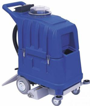
Injecteur extracteur compact pour moquette et carrelage à traction manuelle. La machine lave, brosse et sèche une bande de 50 cm de moquette, jusqu'à 500 mètres carrés dans une heure, en marchant avant. Le moteur à 3 étages à haute dépression permet d'obtenir un excellent essorage dans un temps très court. Un extracteur très silencieux : 60 décibel seulement.
