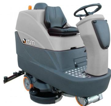
Autolaveuse autoportée fiable et adaptée à tous les travaux de nettoyage intensifs. Elle s'accommodera aisément des grandes surfaces avec une capacité de 200l d'eau propre et une largeur de brosse de 102cm. Son haut rendement (7140m<sup>2</sup>/h) et sa grande maniabilité sont parmi les principaux avantages de cette autolaveuse. Sa maintenance simplifiée et sa robustesse en font une autolaveuse compacte très économique.Jusqu'à 5h d'autonomie. Brosses incluses.
