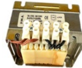
Transformateur d'alimentation entrée 220-400V. sortie 24V 35VA.
