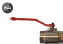
Vanne HP à sphère 2 voies inox G 1/2 F x2 210 bars 30L/mn
