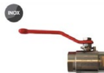
Vanne HP à sphère 2 voies inox G 3/8 F x2 210 bars 90L/mn
