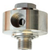
Raccord HP tournant angle 90° inox G 3/8 M G 3/8 F (entrée enrouleur)
